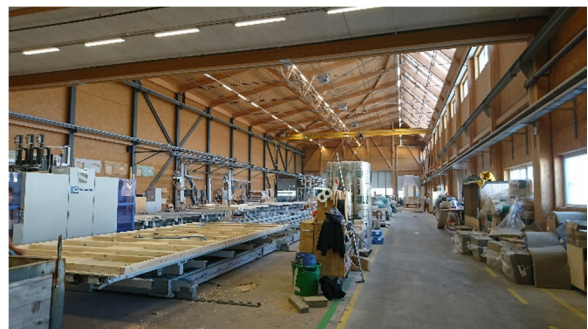
Abbildung 3: Elementfertigung für Module, Blumer-Lehmann AG / Schweiz
