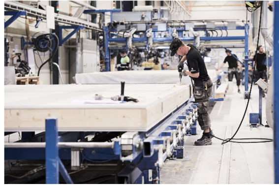
Abbildung 22: Fertigung der Wandelemente
