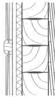
Ab Ende des 19. Jhd. Strickwand mit Verschindelung außen und dünner Dämmung hinter Täfer innen
