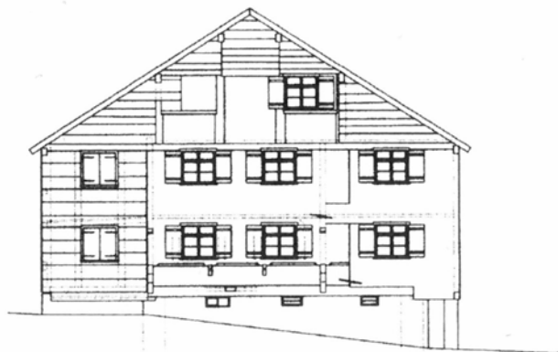
Verbreiterung des Hauses nordseitig und des Schopfs südseitig, Dachaufsteilung - Egg, Fallenbach96
