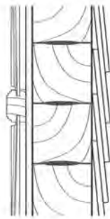
Ab ca. 1850 Strickwand mit Verschindelung außen und Täfer innen
